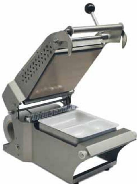
Dieses aus Edelstahl gefertigte Siegelgerät ist mit Rollenhalter und Schneidevorrichtung ausgestattet. Der Rollenhalter eignet sich hervorragend für die Versiegelung mit Aluminium und Klarsichtfolie. Das Gerät besticht durch seine bedienerfreundliche und effiziente Arbeitsweise. Eine sekundenschnelle Versiegelung von bis zu 400 Schalen pro Stunde wird garantiert. Für einen schnellen Rahmenwechsel bietet das Siegelgerät ein praktisches Ablagefach direkt unter der Siegelfläche.
