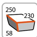
Unser kompaktes Siegelgerät verarbeitet Schalen bis zu einer Größe von max. 250 x 230 mm. Zum Arbeiten mit Aluminium-Zuschnitten und für die meisten BS-ISO-Schalen geeignet.
