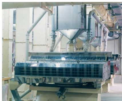
Падди-машина ШУЛЕ на рисозаводе в Греции
