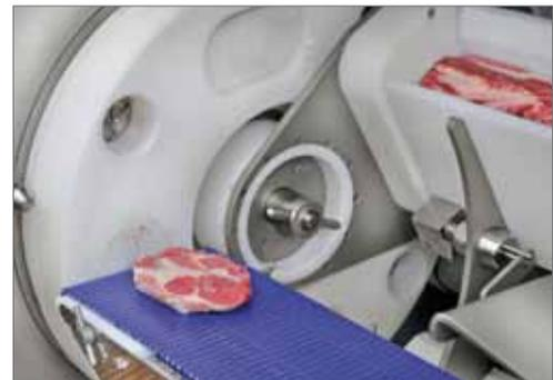
благодаря вращающейся камере производится непрерывная загрузка машины.
