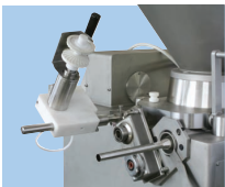
• Il passaggio da l'insacco in continuo al processo di arricciatura avviene rapidamente e senza attrezzi. • The change from straight filling to the twisting process can be done quickly and without tools. ☐ El paso de la fase de embudo en continuo al proceso de retorsión se produce rápidamente y sin herramientas.
