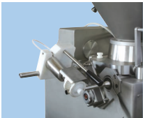
• L' Arricciatore permette di incrementare la produttività dell'operatore quando viene usato bustello naturale. Un motore pneumatico consente di infilare rapidamente negli imbuto d'insacco tutti i bustelli naturali senza danneggiarli. ■ The Casting Applicator increases output when using natural casing. The pneumatic drive unit draws all natural casings over any filling tubes without damaging them. ☐ L' Alendador de tripa permite incrementar la productividad del operario cuando se usa tripa natural. Un motor neumático da la posibilidad de introducir rápidamente en los embudos de llenado todos los tripas naturales sin dañarlas.
