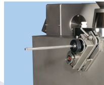
• Il dispositivo Attorcigliatore permette di essere approntato rapidamente senza uso di utensili. ■ The Twist Linker is ready quickly and without tools. ☐ El dispositivo Retorcedor permite ser preparado rápidamente sin empleo de herramientas.
