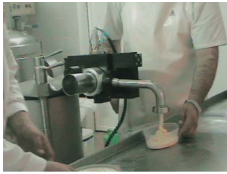
Dosificador con embudo con válvula anti-goteo Portioner with anti-dripping valve Doseur avec valve anti-goutter Dosierer mit Trichter mit Ventil tropfe ich
