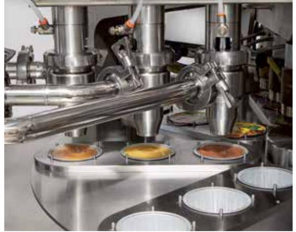
Dosatore volumetrico elettronico con otturatore lineare / *Electronic volumetric doser with linear dispenser heads* / *Doseur Volumétrique électronique avec obturateur linéaire* / *Объемный электронный дозатор с линейным затвором*
