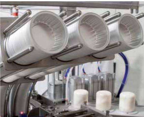
Magazzino di grande capacità / *High capacity storage* / Magasin haute capacité / Накопитель большой мощности
