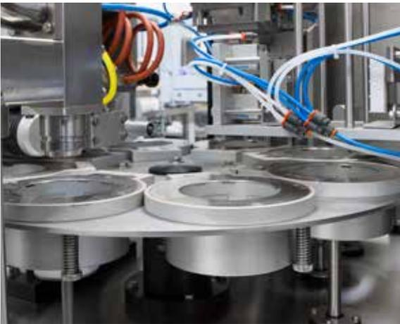
Impianto vuoto/gas per confezionamento prodotti in ATM / *Vacuum/Gas system for packaging in MAP* / Plant vide/gaz pour conditionnement des produits sous atmosphère protectrice / Система вакуум/газ для упаковки с модифицированной газовой средой
