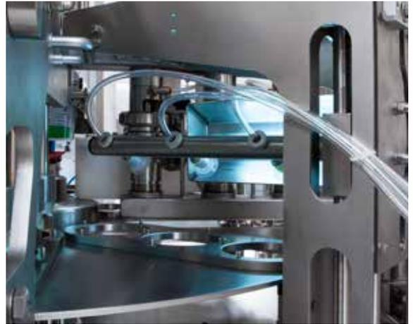
Lampade UV per sanificazioni capsule di alluminio / *UV Lamps to sanitize pre-cut foil lids* / *Lampes UV pour assainissement des opercules alu* / *УФ-лампы для обработки платинок*
