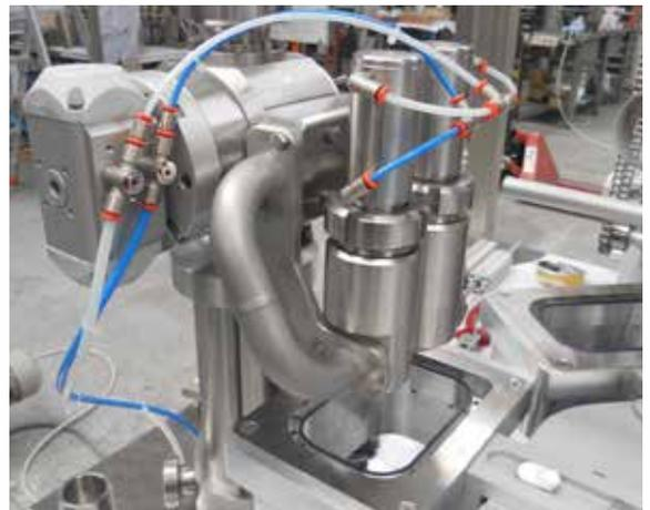
Dosaggio per parti solide di grosse dimensioni con valvola a distribuzione rotante / *Specialised dosing system for larger solid particles with distributional rotating valve* / Dosage des particules solides de grandes dimensions par soupape rotative / Специальная система дозации для больших жестких включений в продукте с помощью роторного распределительного вентиля
