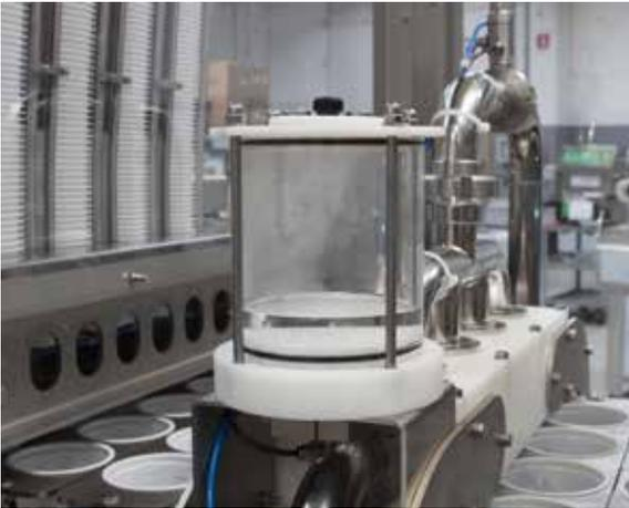
Sistema  $H_2O_2$  per sanificazione contenitori /  *$H_2O_2$  system to sanitize cups* / *Système  $H_2O_2$  pour l'assainissement des conteneurs* /  *$H_2O_2$  система для обработки стаканчиков*
