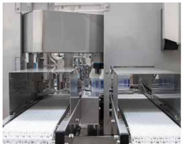
Caricamento contenitori pieni tramite nastro motorizzato / *Filled containers loading with motorized in-feed conveyor* / Chargement des conteneurs remplis par tapis motorisé / Загрузка наполненных контейнеров с помощью моторизованного подающего конвейера
