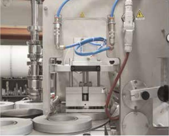
Svolgimento e riavvolgimento film con stazione saldatura e taglio / *Unwinding and rewinding film with sealing and cutting station* / Déroulement et Enroulement du film avec station de scellage et découpe / Размотка и смотка пленки для станции запайки и обрезки
