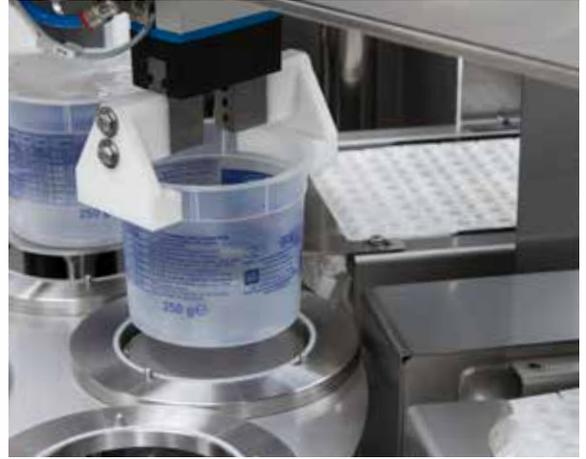
Sistema alimentazione contenitori con nastro motorizzato pick&place / *Pick & Place system with motorized in-feed conveyor* / Systeme d'alimentation des conteneurs par tapis motorisé type Pick&Place / Система Pick & Place с моторизованным подающим конвейером для подачи контейнеров
