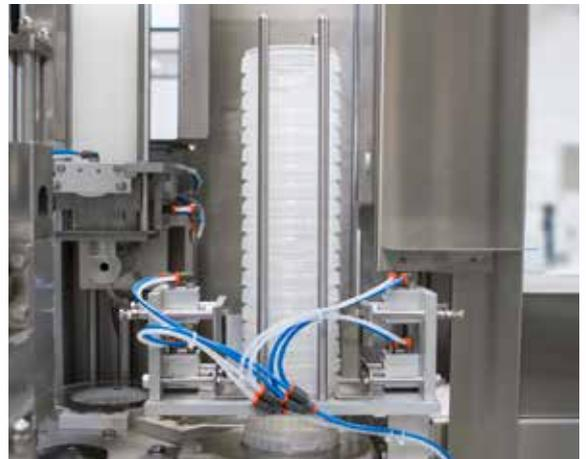
Dispositivo automatico posizionamento coperchi salva aroma / *Automatic positioning device for lids* / *Dispositif automatique pour positionnement des couvercles de bouchage* / *Автоматическая система позиционирования крышки*
