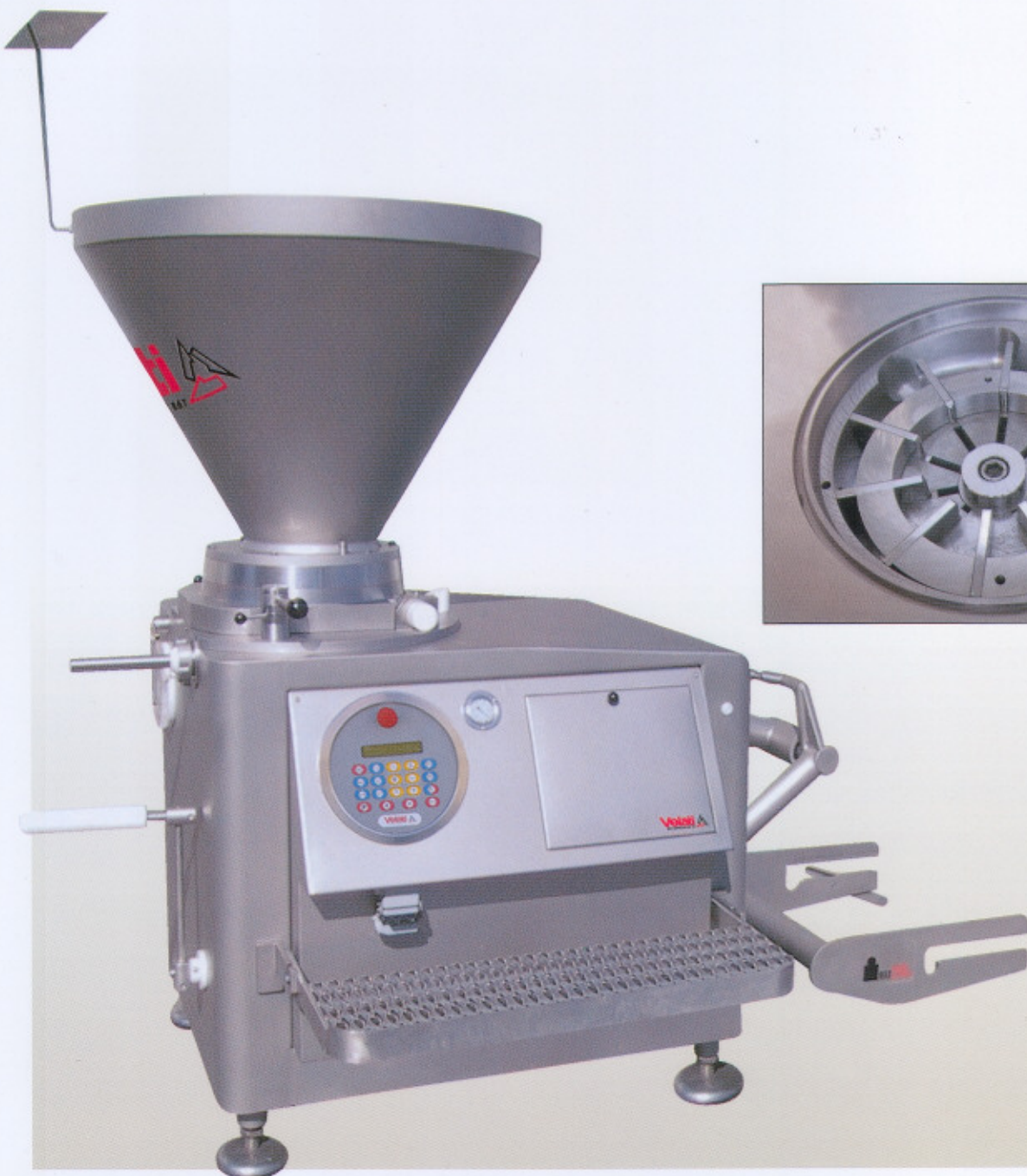
Rotore a 10 palette Rotor with 10 paddles
