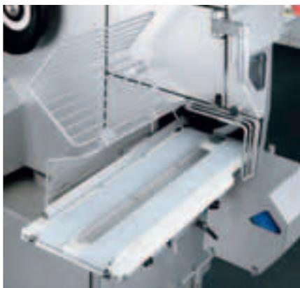
*Выгрузка продукта - регулируемый транспортер с двойной конвейерной лентой идеально подходит для круглых колбас.*
