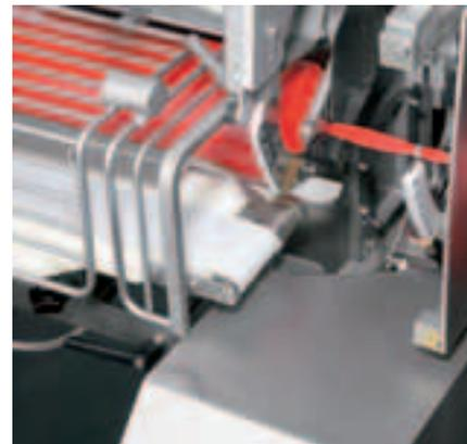
Подпрессовка до 130 мм для вакуумного наполнения формованных продуктов
