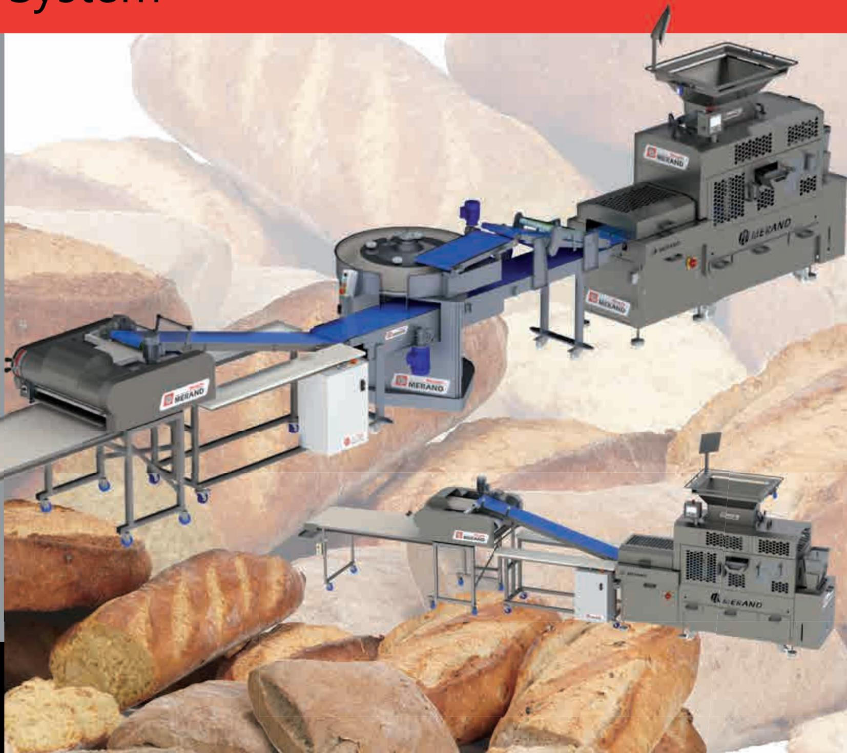
La diviseuse RheoPan® Precision, constitue la base du RheoPan® System. Grâce au pesage des pâtons et à l'ajustement automatique des réglages, elle divise avec une très grande précision, aussi bien des pâtes fortement hydratées, que des pâtes dures.
