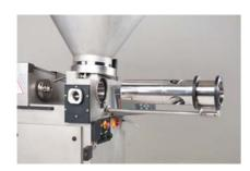
Con nuestro sistema de desmontaje de la máquina, podemos acceder a todos los lugares y rincones por donde pasa la masa, consiguiendo una limpieza rápida y eficaz, lo que le dará una mayor durabilidad a la máquina. El alimentador y la corona, se desmontan fácilmente para dejar paso a una tolva sin obstáculos para su limpieza.
