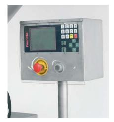
El nuevo procesador incorpora el sistema de dosificación, la salida de clipadora, e incluso controla la presión de la masa para la correcta dosificación, con un sistema de test para las posibles averías y una pantalla retroiluminada que permite acceder a toda la información del funcionamiento de la máquina.
