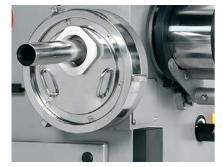
En versión ECC-PG, hemos incorporado una guillotina en la boca de salida, la cual no reduce el diámetro de la misma, y nos permite porcionar todo tipo de masas, tanto trozos pequeños como grandes. Mediante una simple tuerca podemos desmontar completamente la guillotina, esto nos permite realizar una limpieza rápida y eficaz de esta.
