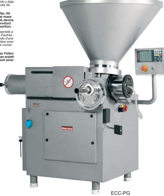
Nuevo concepto de embutidora al vacío de dos pistones con accionamiento coaxial, cuyo funcionamiento permite, que mientras un cilindro admite la masa haciendo el vacío, simultáneamente, el otro descarga el producto. Esta operación se produce alternativamente. El vacío se realiza durante todo el proceso de carga a través de los pistones, lo que nos permite extraer en alto grado el aire de la masa
