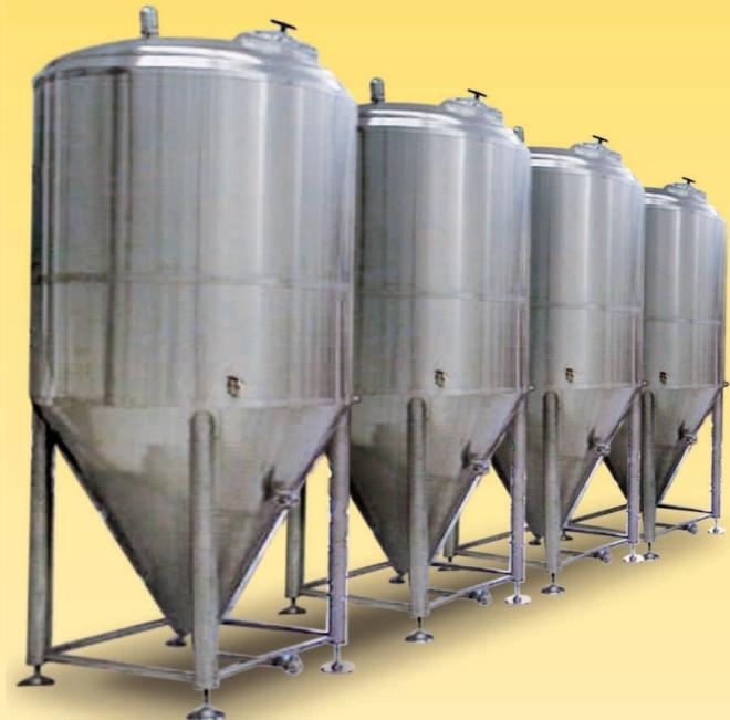
Je to vertikálna, valcovo-kužeľová nádoba slúžiaca na kvasenie a zrenie piva. Tank je vybavený nezávislými chladiacimi zónami a je umiestnený na nastaviteľných nohách.
