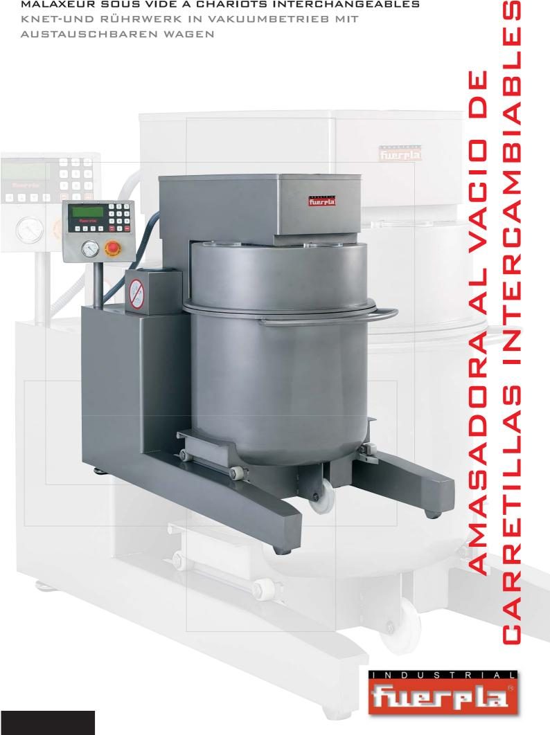
Ordenador para el control de tiempos de amasado y vacío, avisador acústico, apertura hidráulica de la tapa, test de errores, y programación de los diferentes sistemas de amasado, según los productos a procesar.
