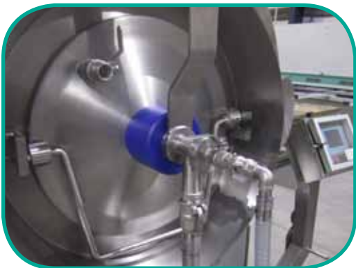
option: Lakedosierung während Rotation Option: brine dosage during rotation
