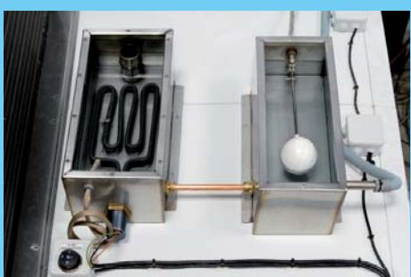
Der leistungsstarke Dampfgenerator mit 2,2 kW ist fähig die Kammer in nur wenigen Sekunden voller Feuchtigkeit zu sätten. Sein einfaches und ausgeklügeltes Design als verbundener Doppelbehälter sättigt nicht den Widerstand mit Wasser und erweist sich dadurch als energiesparend.
