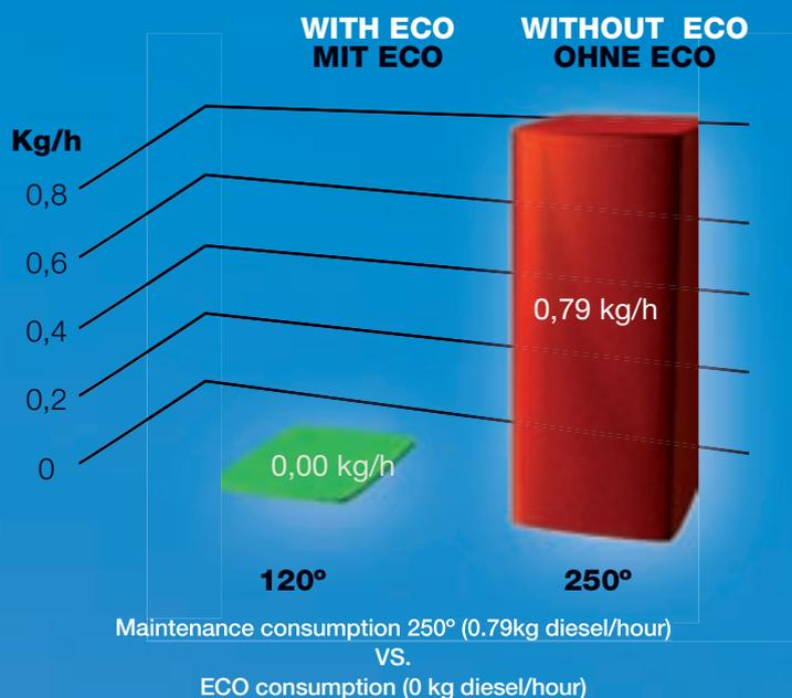
Energieverbrauch bei einer Haltetemperatur von 250° (0,79kg Diesel/Stunde) gegenüber Energieverbrauch ECO (0 kg Diesel/Stunde)
