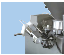
● L' Arrotatore permette di incrementare la produttività dell'operatore quando viene usato buccello naturale. ● The casing applier increases output when using natural casing. The pneumatic drive unit draws off natural casings over any filling tube without damaging them.
