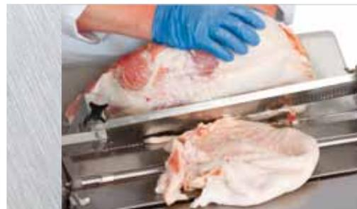
для оптимизации процесса за один и тот же рабочий цикл производится две операции: снятие шкурки и обезжиривание.
