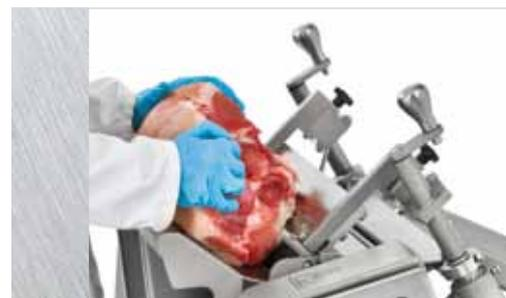
Рычаг справа и слева для регулирования уровня толщины жира/шпика.
