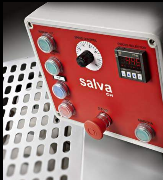
Controllable speed using electronic variator and oversized transmission. Per elektronischem Drehzahlregler steuerbare Geschwindigkeit und überdimensionierte Kraftübertragung.
