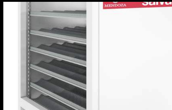
With 14 tray accumulator (+5 in reception) Mit Blechmagazin für 14 Bleche (+5 am Einlauf).
