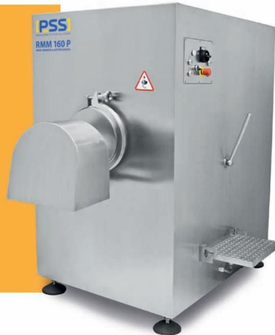
PSS RMM мясорубки для замороженного мяса предназначены для цехов пищевой промышленности, для быстрого и бережного измельчения любого вида замороженного мяса, предварительно измельченного на блокорезке или ленточной пиле с температурой до -10°C, а также для измель-
