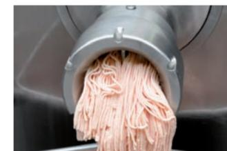
PSS RMM изготовлены из пищевой нержавеющей стали AISI 304, все наружные и внутренние поверхности, вступающие в контакт с сырьем - полированные. Конструкция PSS RMM сводит к минимуму возникновение бактерий, благодаря чему мясорубки можно смело включать в состав оборудования, которое имеет высокие гигиенические требования. Идеальная герметичность и ровная поверхность позволяют произвести простую и быструю дезинфекцию.
