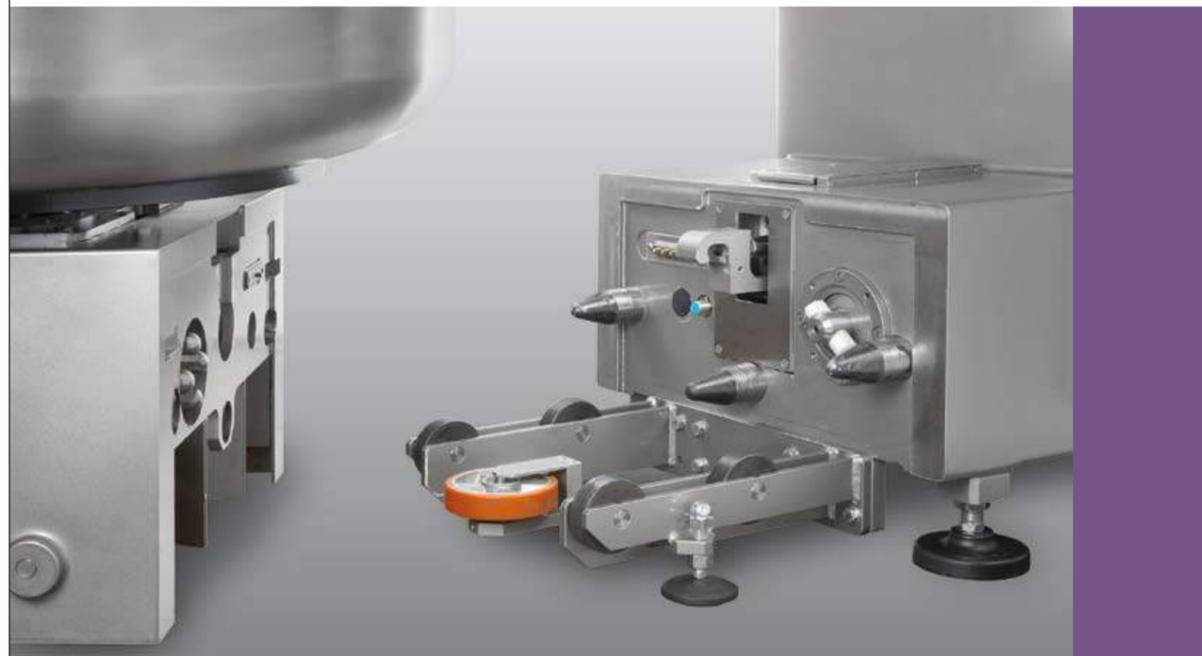
Facile inserimento del carrello con il sistema di aggancio idraulico automatico.
